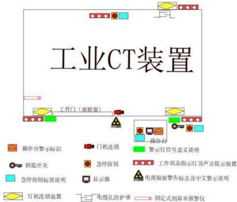
图10-2本项目工业CT装置辐射安全和防护措施示意图
